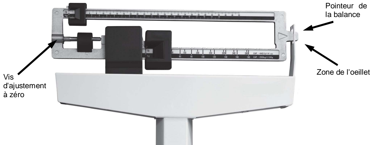
Figure 17. Emplacement de la zone de l'oeillet et de la vis d'ajustement à zéro
