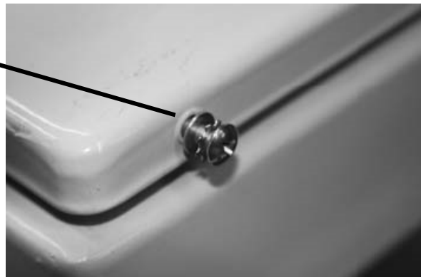
Figure 9. Vis se trouvant sur la plateforme amovible du cadre de support de la balance
