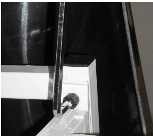
Figure 15. Fixer les accoudoirs au siège moulé
