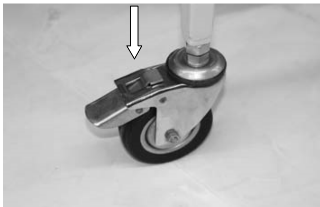
Figure 3. Verrouiller les roues pivotantes afin que l'unité reste immobile
