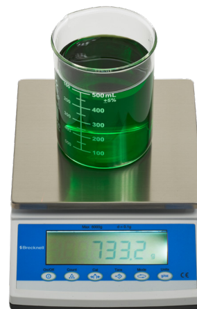
La MBS1200 et la MBS3000 sont équipées d'un plateau de pesée carré en acier inoxydable.
